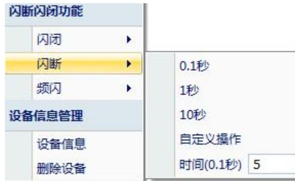
**注：闪断闪开模式不能写入设备芯片内，软件上选择闪断闪开模式后，所有通道都为闪断闪开模式下，可通过发送单个通道的闪断闪开指令来进行单个通道的控制，不影响其他通道的正常控制。**
