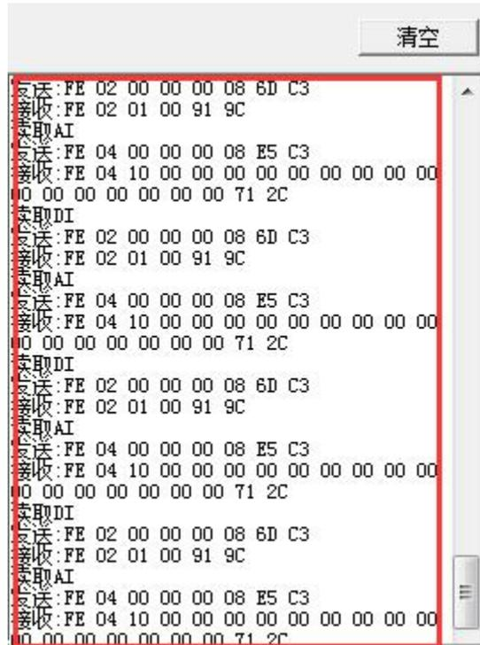
指令生成说明：对于下表中没有的指令，用户可以自己根据 modbus 协议生成，对于继电器线圈的读写，实际就是对 modbus 寄存器中的线圈寄存器的读写，上文中已经说明了继电器寄存器的地址，用户只需生成对寄存器操作的读写指令即可。例如读或者写继电器 1 的状态，实际上是对继电器 1 对应的线圈寄存器 00001 的读写操作。
