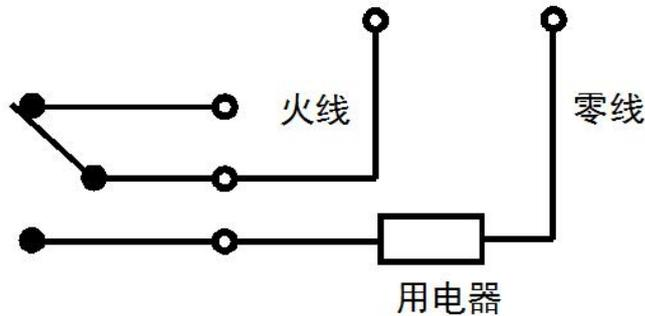
继电器输出触点容量最大为 AC250V 10A，单刀双掷。
