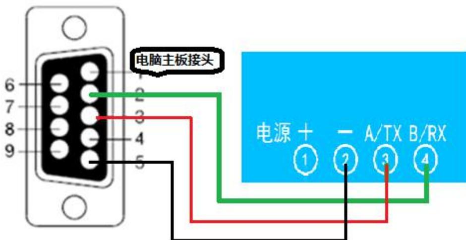
232 通讯使用 2 脚 (TX)、3 脚 (RX)、5 脚 (GND)。其中 5 脚地线与设备上的电源负极共用。当设备通讯不上时，可检测串口线是否为直连线，将 RX 和 TX 进行交换测试。
